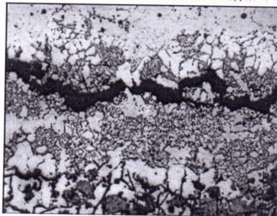
Рис. 6. Фрагмент микроструктуры зоны сплавления сварного соединения серого чугуна с продольной трещиной (отрывом), \times 150
