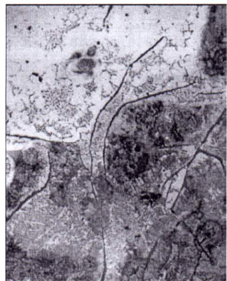
Рис. 3. Микроструктура металла зоны сплавления без ледебурита в сварном соединении, выполненном высоконикелевым электродом без подогрева и последующей термообработки, \times 250
